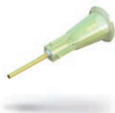
Einmal-Kanüle zur Extraktion viskoser Flüssigkeiten, dünnwandige 14 mm-Polyimidspitze. (20 G/0,9 mm) Artikel-Nr.: 1272.VFE20
